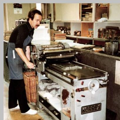
Korrekturabzug mittels Abziehpresse in den 80er Jahren
