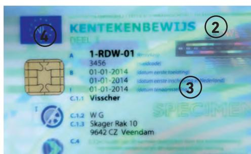
Ein farbloser Grundstoff, der mit mikroskopisch kleinen und mehrschichtigen Flocken bzw. Pigmenten durchsetzt ist. Je nach Blickwinkel nehmen die Flocken einen anderen Farbton an.
